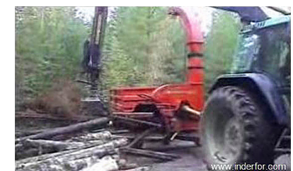
Fotografía 1. Astilladora impulsada por tractor-grúa.
