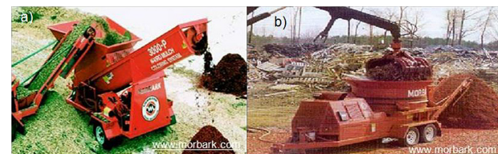
Fotografías 5 y 6. Máquinas estacionarias para producir mulch.
