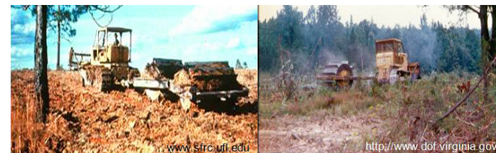
Fotografías 1 y 2. Rodillo triturador de residuos en piso.
