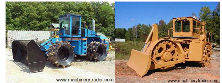
Fotografía 16. Compactador-triturador de residuos.
