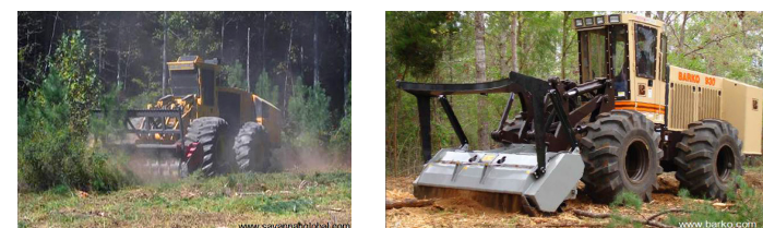
Fotografía 3. Mulcher en pleno trabajo de mulchado en faenas forestales. Fotografía 4. Mulcher Barko de 305 HP.
